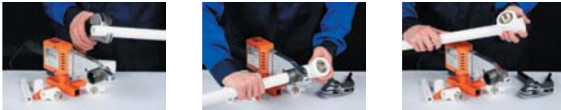
Рисунок 2. Последовательность процесса контактной сварки в раструб трубы и муфты из PPR.
